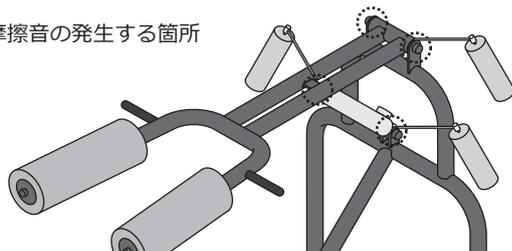
● 付属のグリーススプレーで3ヶ月を目安に可動部分に適量吹き付けてください。給油を怠ると、がたつきや摩擦音の原因となります。
