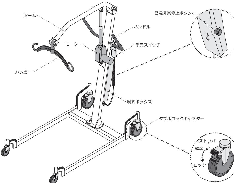
ボタンを押し込むと電源を遮断し、リフトの動きが停止します。時計回りに回すと解除されます。
