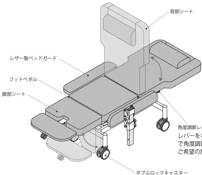
●油圧ポンプの構造上、ベッドを昇降させることにより油圧ポンプ内の油に気泡ができることがあります。気泡は時間が経つと破裂し、その反動によりベッド高が最大5cm程度下がることがあります。製品特性上の現象であり、故障及び不具合ではありません。その際には、ベッドを一番上から一番下に下げる動作を5~6回程度繰り返し行ってください。それにより油圧ポンプ内の気泡を除去することができ、ベッドが自然に下がることを防止できます。また、フットペダルを使用せずにベッドを持ち上げて高さ調節された場合にも油圧ポンプ内の油に気泡ができることがありますのでご注意ください。
