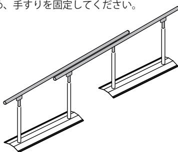
下図のように、支柱にM8六角穴付きボルトを差し込み、手すりと支柱を
