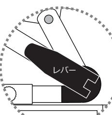
レバーを手前に引く事でロックが解除され、フェイス部の位置を無段階で調節できます。
