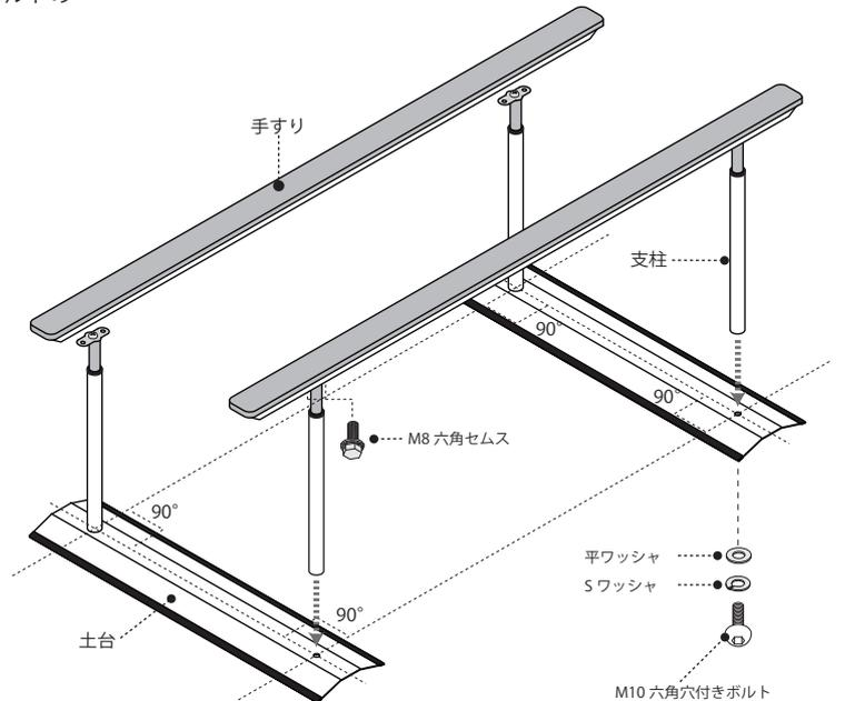
※組立後がたつきがある場合は、一旦ボルトを緩めていただき、再度水平な場所に設置してボルトの増し締めを行ってください。
