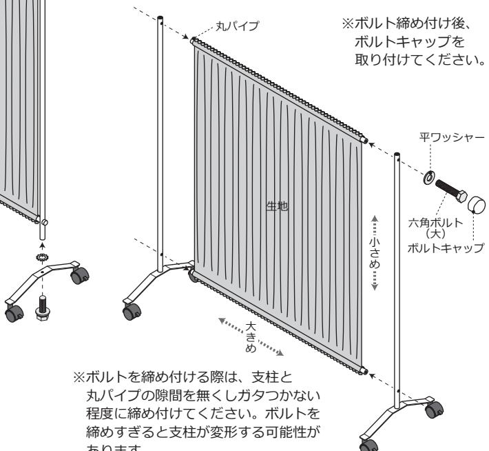
※ボルトを締め付ける際は、支柱と丸パイプの隙間を無くしがたつかない程度に締め付けてください。ボルトを締めすぎると支柱が変形する可能性があります。
