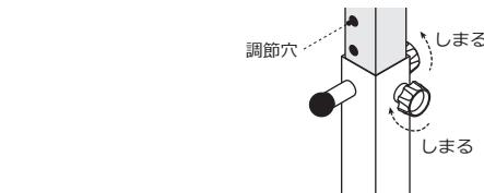
支柱に空いている調節穴に、安全ストッパーのピンが入ることにより、高さがロックされます。ご希望の高さに調整し、ノブネジをしめ固定してください。
