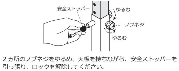
2カ所のノブネジをゆるめ、天板を持ちながら、安全ストッパーを引っ張り、ロックを解除してください。
