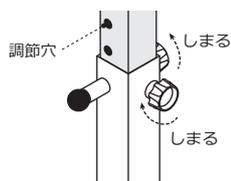
支柱に空いている調節穴に、安全ストッパーのピンが入ることにより、高さがロックされます。ご希望の高さに調整し、ノブネジをしめ固定してください。
