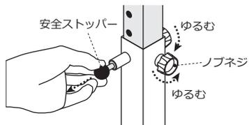
2カ所のノブネジをゆるめ、手すりの両端を二人で持ちながら、安全ストッパーを引っ張り、ロックを解除してください。
