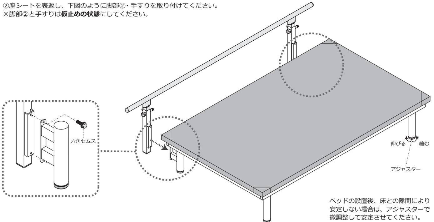
③手すりの支柱がフレームの中心になるよう微調整した後、脚部②と手すり、脚部②と座シートの順番で、六角セムスをしっかりと止めてください。
