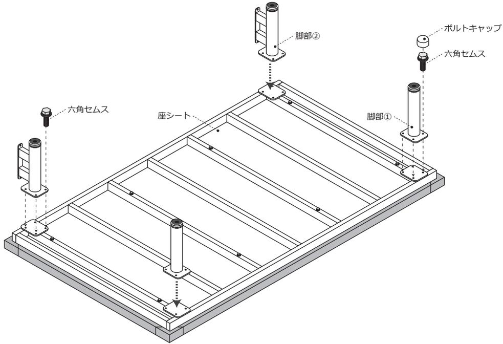
②座シートを表返し、下図のように脚部②・手すりを取り付けてください。
