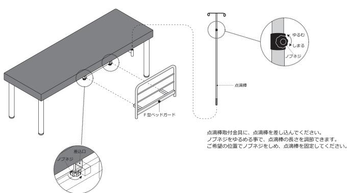
差込口にベッドガードを差し込み、ノブネジ(2カ所)をしめ、 しっかり固定してください。ガタつきや脱落の原因となります。
