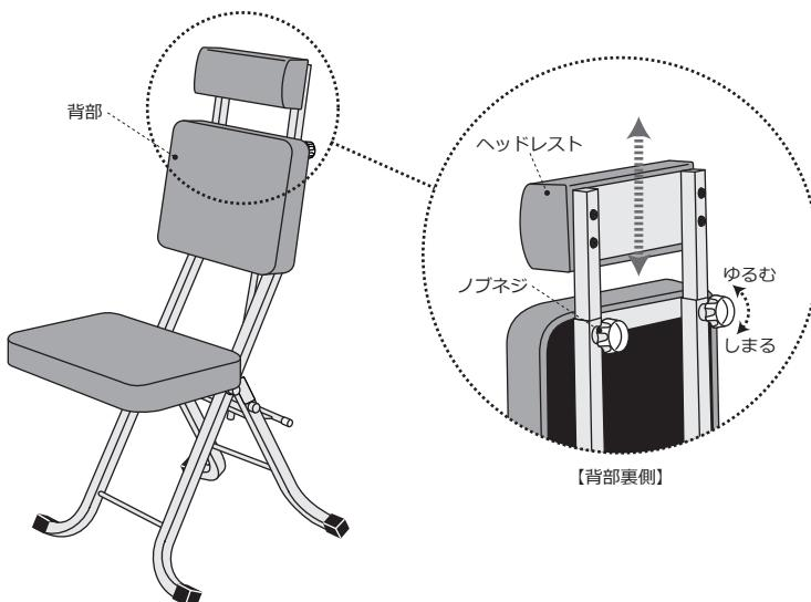
背部裏側のノブネジ（2カ所）をゆるめることで、ヘッドレストの高さを調節することができます。ご希望のヘッドレスト位置でノブネジをしめ、ヘッドレストを固定してください。
