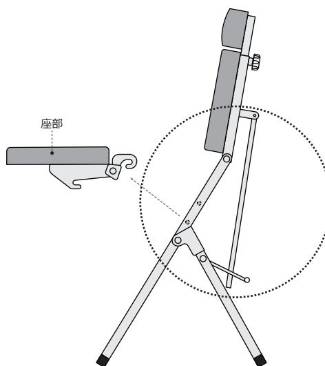
①座部を取り外し、右上図のようにバーをA Lレバーから取り外してください。
