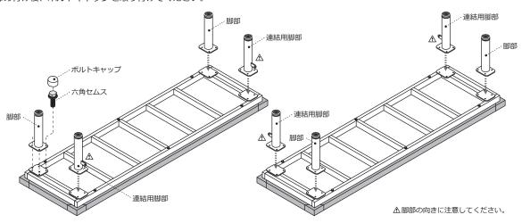
②下図のように、ノブネジで連結バーを取り付けてください。
