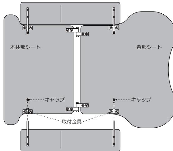
△手置き部は必ず下図のように、折れ曲がる箇所から長い方を背部シート、短い方を本体部シートに取り付けてください。
