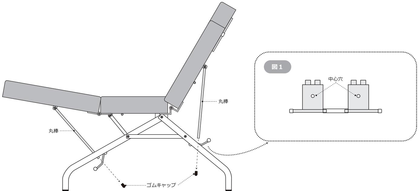
⑤手置き部の丸棒を取付金具に差し込んでください。その後、丸棒の先端にキャップ（合計4ヶ所）をしっかり差し込んでください。
