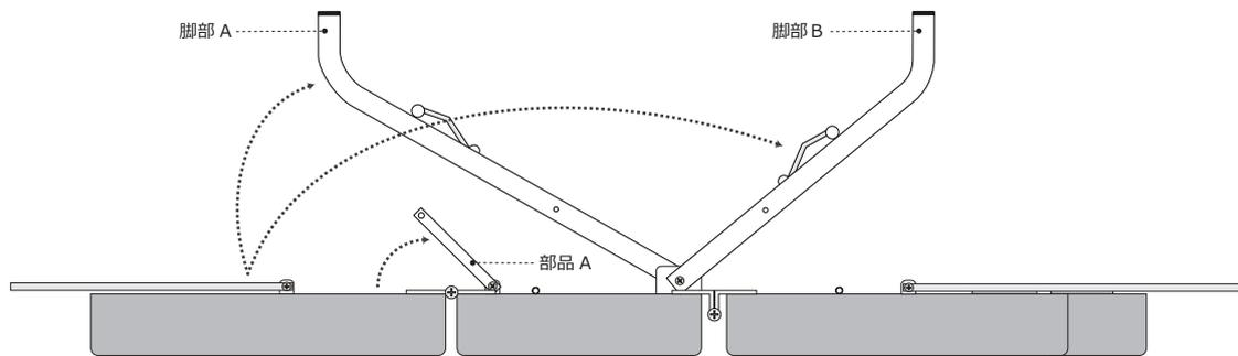
③下図のように、脚部接続バーで脚部 A・B、部品 A を固定してください。(合計 4ヶ所)
