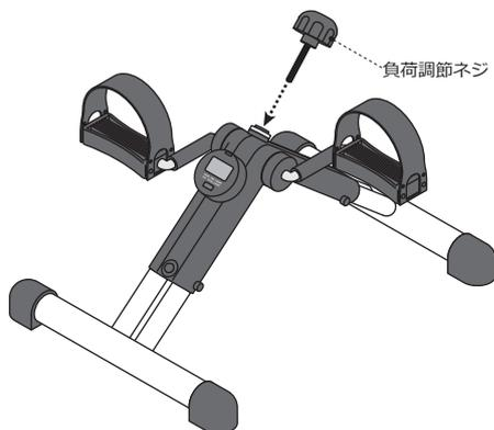
④負荷調節ネジを回す事で、ペダルの負荷を調節する事ができます。ご希望の負荷に調節してご使用ください。
