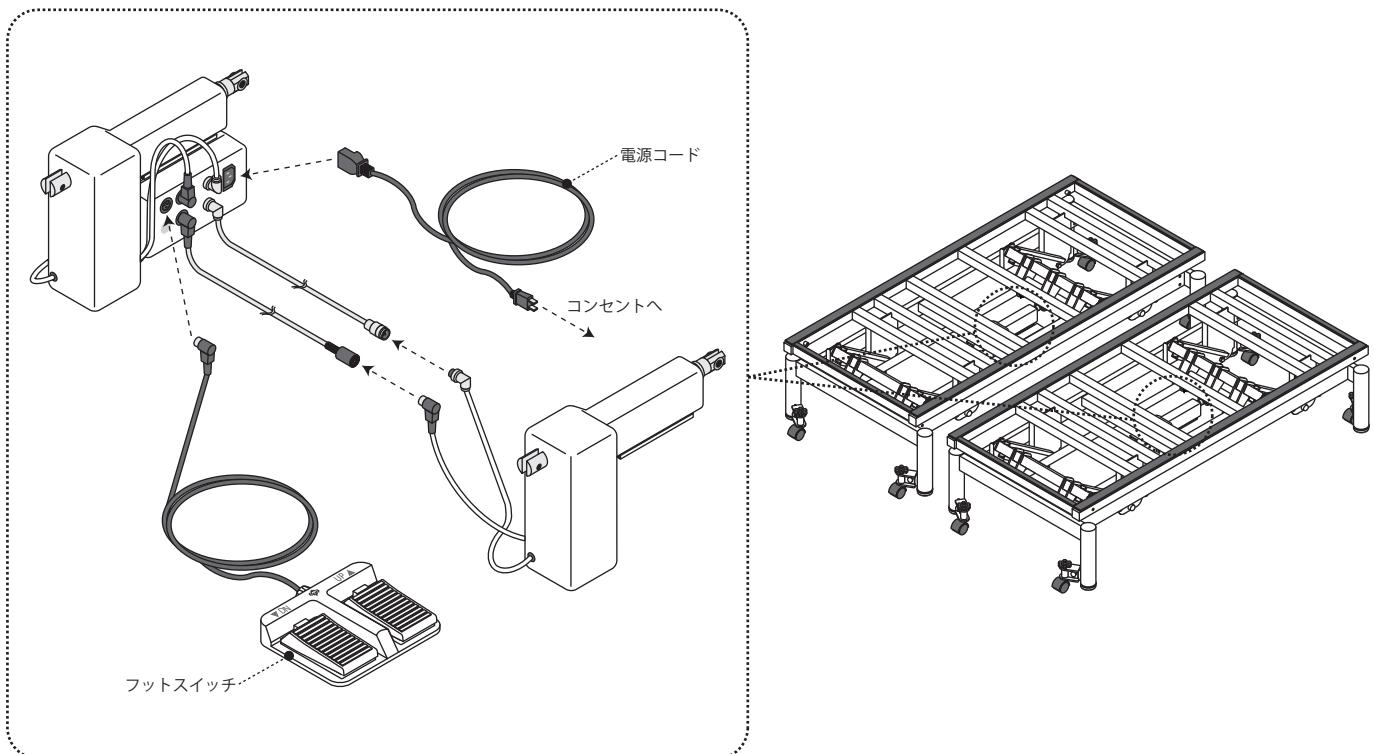
③フットスイッチのUP▲側のペダルを踏み、スチールフレームを最上限の高さまで上昇させてください。
