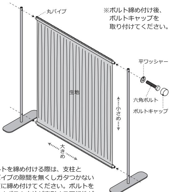
※ボルトを締め付ける際は、支柱と丸パイプの隙間を無くしガタつかない程度に締め付けてください。ボルトを締めすぎると支柱が変形する可能性があります。
