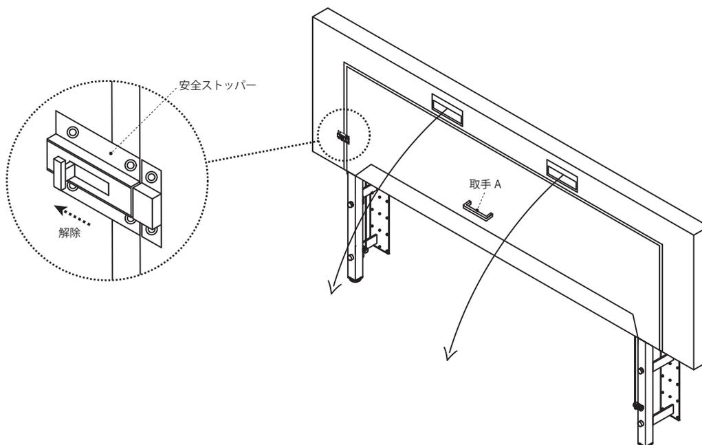
【収納方法】取手 B を持ち、壁面へ押し上げてください。取手 A を壁面へ押しあて、安全ストッパーでロックしてください。
