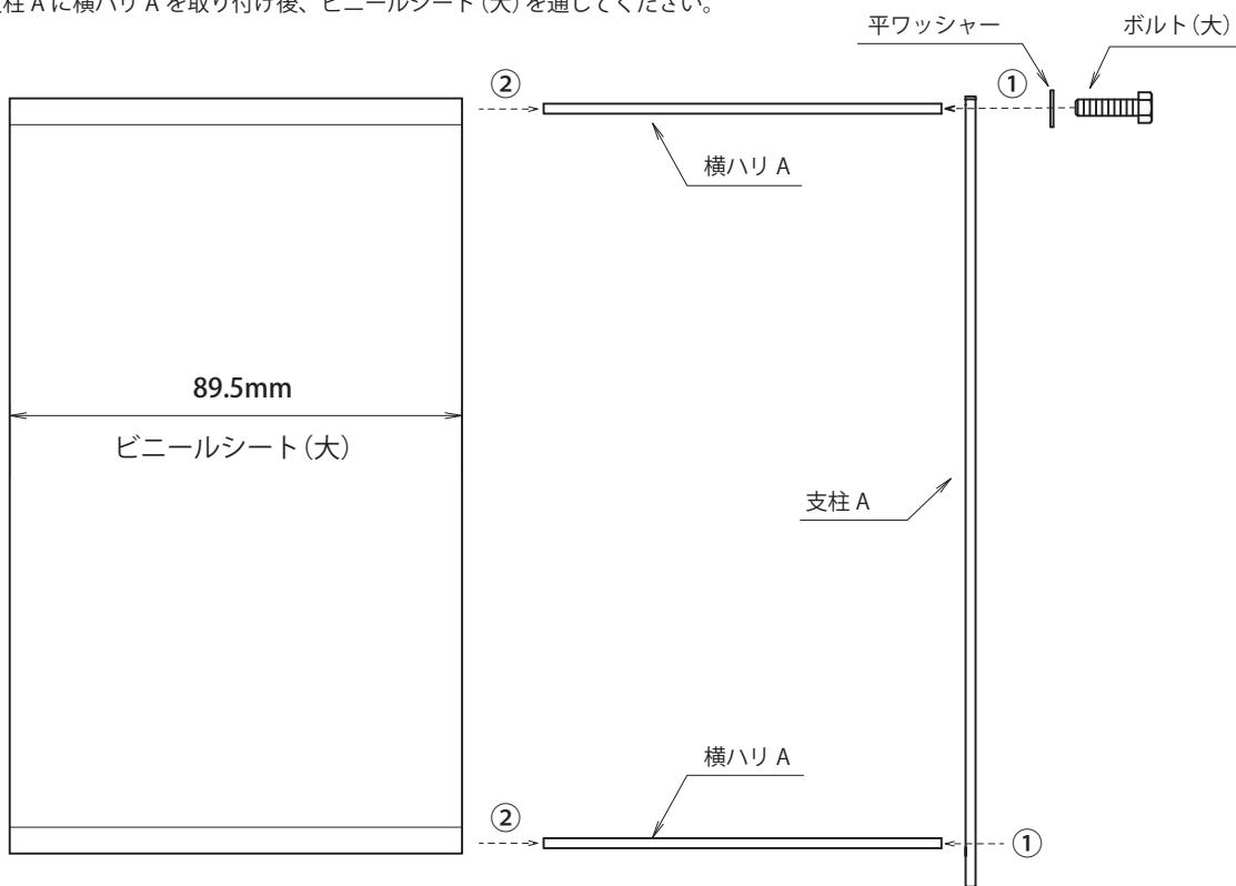
※ボルトを締め付ける際は、支柱と丸パイプの隙間を無くしがたつかない程度に締め付けてください。
