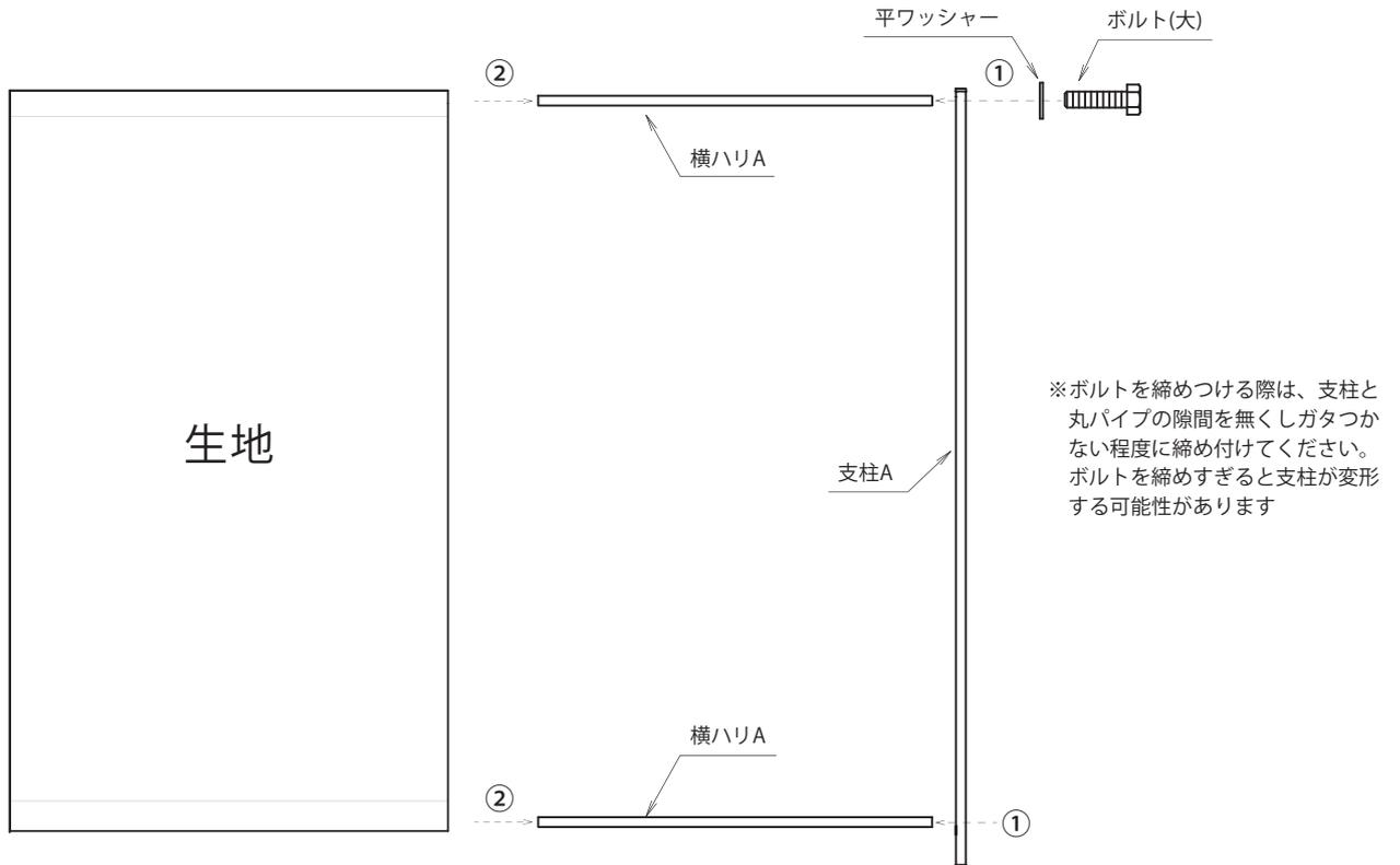
②もう片側の支柱Aを取り付け後、下図のように脚部を取り付けてください。
