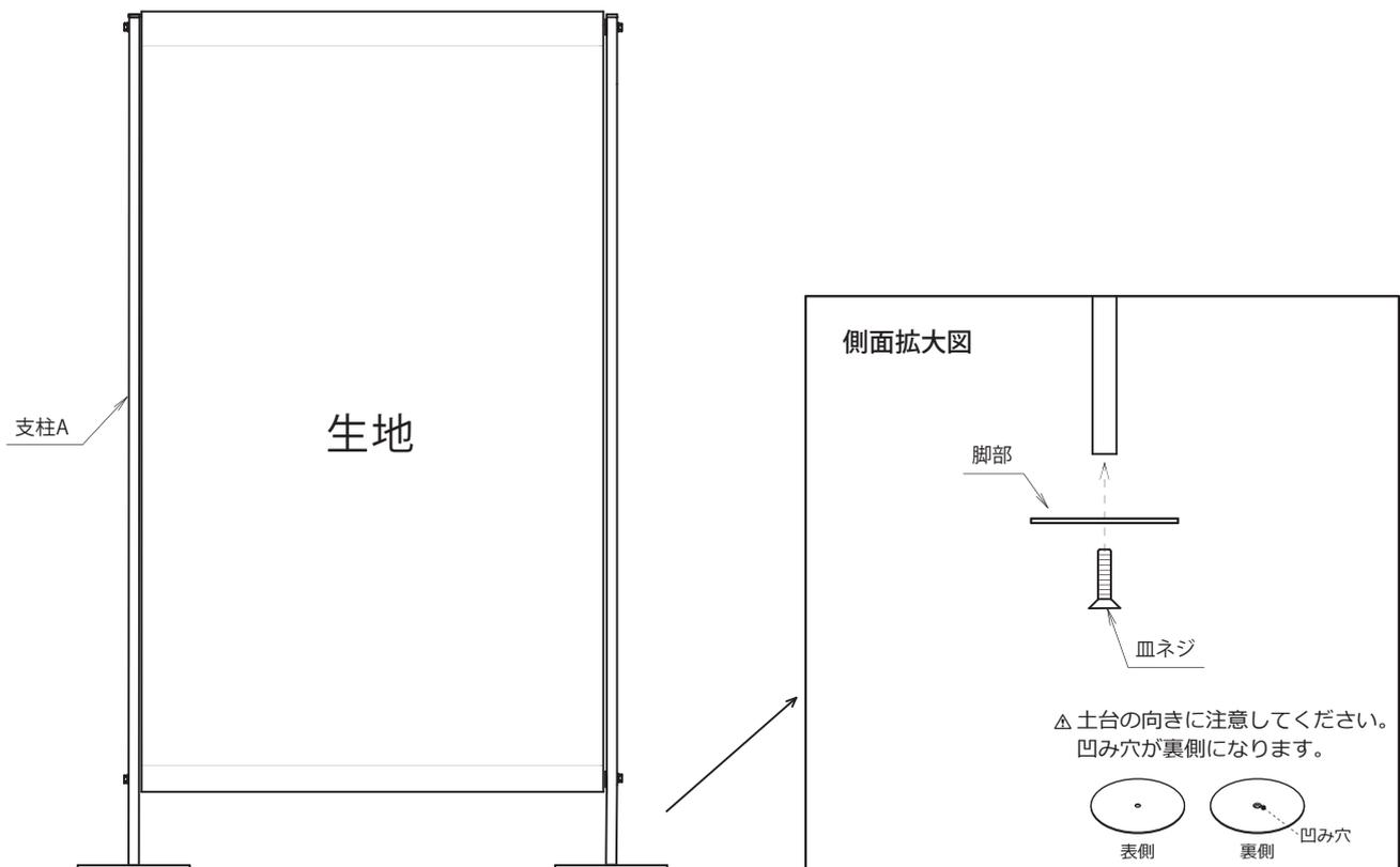
①下図のように支柱Cに横ハリBを取り付け後、生地を通してください。
