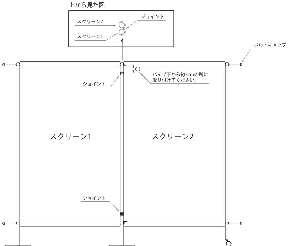
※ガタつき確認後、ボルトキャップ(6カ所)を取り付けてください。
