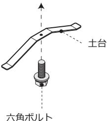
※ボルトを締め付ける際は、土台と丸パイプの隙間を無くしガタつかない程度に締め付けてください。
