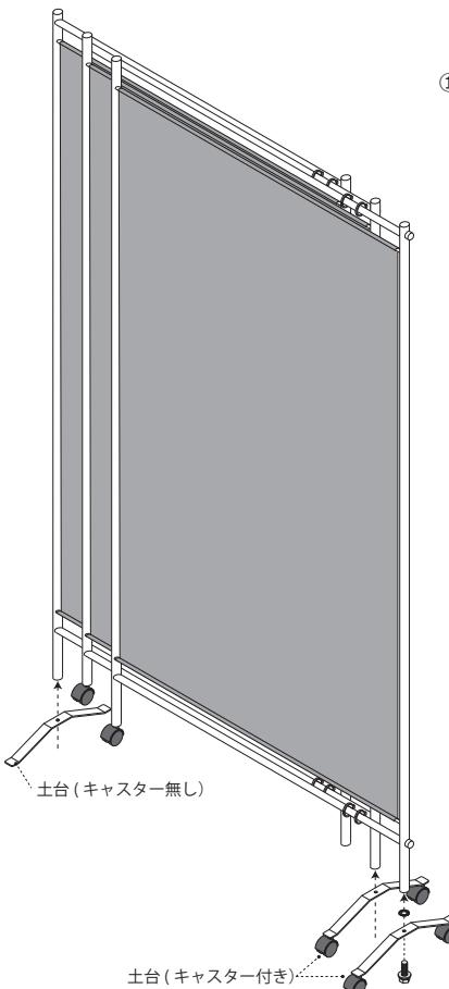
①下図のように支柱に土台を取り付けてください。
