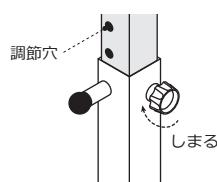
支柱に空いている調節穴に、安全ストッパーのピンが入ることにより、高さがロックされます。ご希望の高さに調整し、ノブネジをしめ固定してください。
