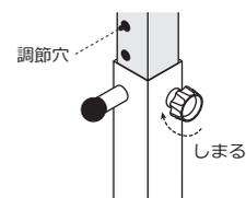
脚部に空いている調節穴に、安全ストッパーのピンが入ることにより、高さがロックされます。ご希望の高さに調整し、ノブネジをしめ固定してください。
