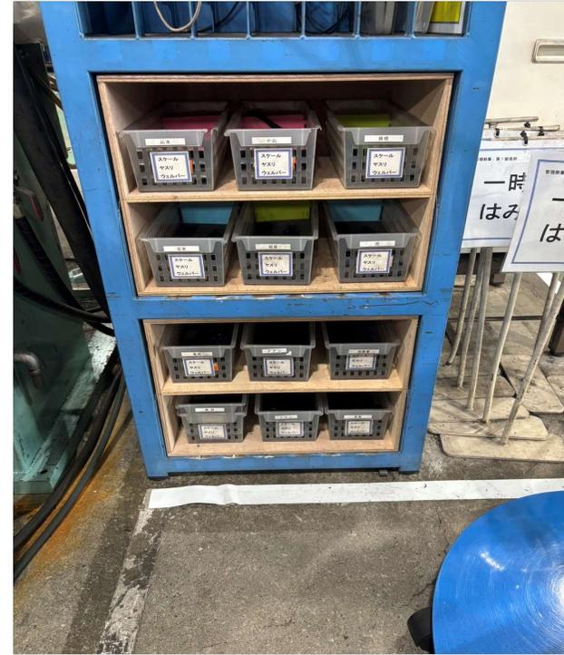
別に台車を再利用して直していた個人の工具類を、図面入れに使用していた棚の仕切りを外し、棚を一つにまとめ工具入れにしました。第3製造部に協力してもらい、箱を製作し見た目も良くなり、棚も一つにした事で場所も効率よく使えるようになりました
