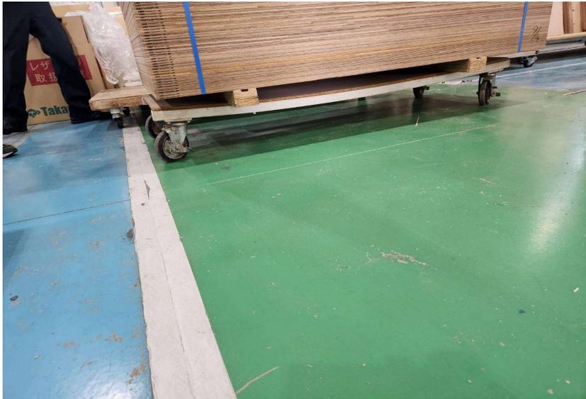
9×3×6ベニヤ12×3×6ベニヤをルーター前に移動させるために台車に乗せていますが、木枠用台車なので台車がたわんでしまっている状態でした。またキャスターの車輪が耐えきれず壊れてしまうこともありました。動かすのに4人で動かしていました。
